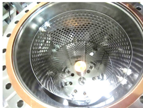
プロトタイプ装置で導入した分割電極
