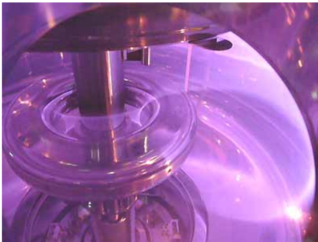
磁気浮上時の磁気面の可視化: 真空磁場の計算値と良い一致を見せる．
