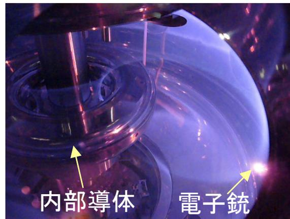
コイル支持状態(内部導体による純dipole磁場)
