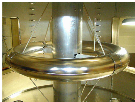
内部導体を取り巻く周回軌道 / ミラートラップされた電子
