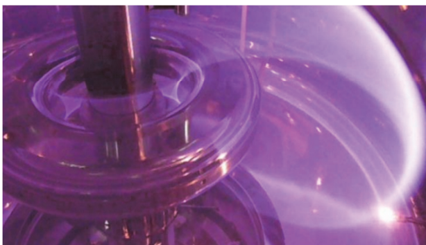
Fig. 4 磁気浮上ダイポール装置 RT-1 で電子ビームの入射により可視化した磁気面の様子。
