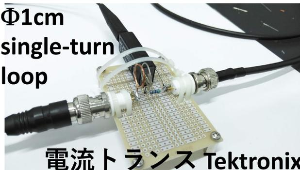
電流トランス Tektronix
