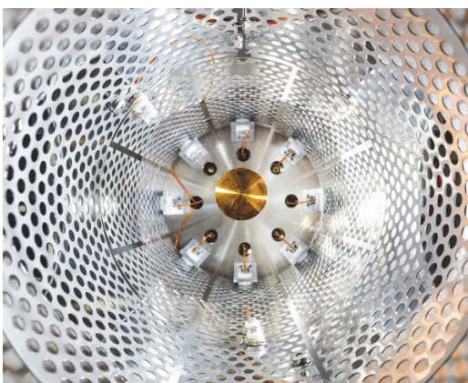
図1: 分割電極を含む、永久磁石を使用したプロトタイプのダイポールトラップ。
